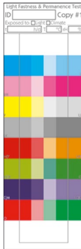
◀ Abb. 1: Layout des Testcharts für die Alterungstests (verkleinerte Darstellung).
